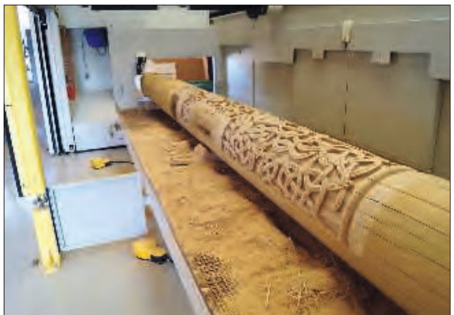
Et hul i maskinens ene side muliggjorde bearbejdningen af de otte meter lange stammer.
